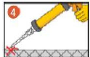
Injectar inmediatamente después el adhesivo en la perforación, comenzando desde el fondo y llevando la boquilla hacia atrás progresivamente mientras la perforación se rellena. Evitar la inclusión de aire. Para anclajes profundos, puede utilizarse un tubo o manguera de extensión.
